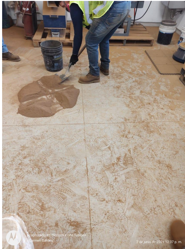
Ilustración 10. Homogenización por cono y cuarteo.
