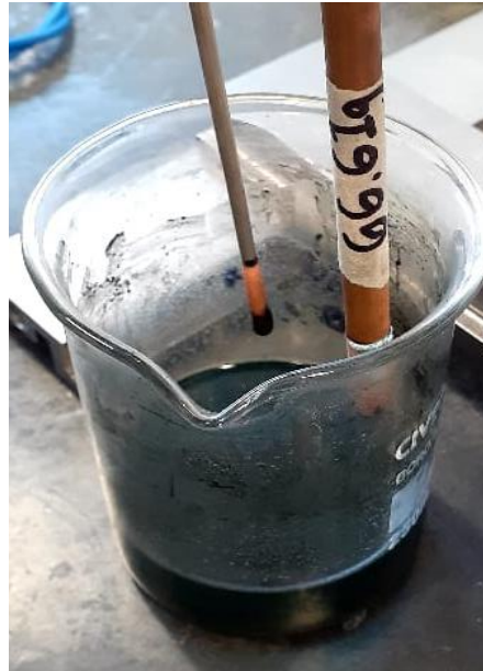
Ilustración 13 captación de cobre a los 5 minutos
